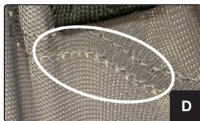
Sømgliedning under belastning (pasientsiden)
