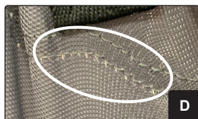
Scivolamento della cucitura sotto carico (lato paziente)
