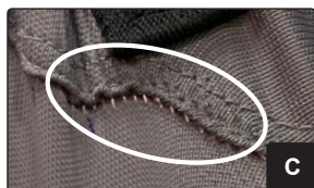
Deslizamento da costura sob carga (Lado do cuidador)
