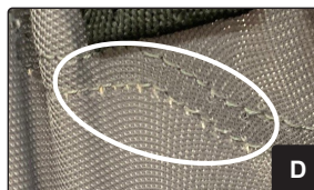
Naad slippen onder belasting (Patiëntzijde)
