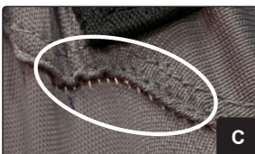
Naad slippen onder belasting (verzorgende kant)
