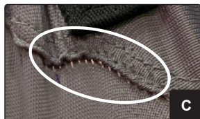
Deslizamiento de la costura bajo carga (Lado del cuidador)
