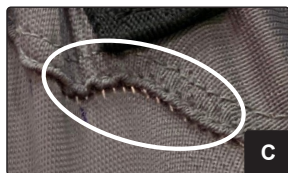
Glissement de couture sous charge (Côté soignant)
