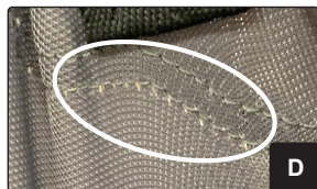
Deslizamiento de la costura bajo carga (Lado del paciente)
