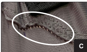
Naht verrutscht unter Last (Aufsichtsseite)
